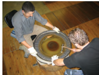
afinación mediante martilleo de los bordes
