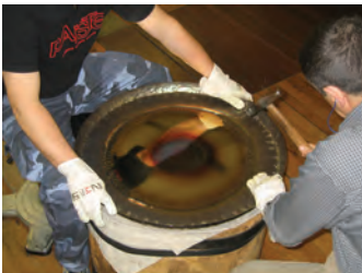
afinación mediante martilleo de los bordes
