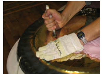
raspado de la superficie
