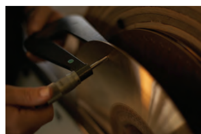
control del parámetro de torneado del plato
