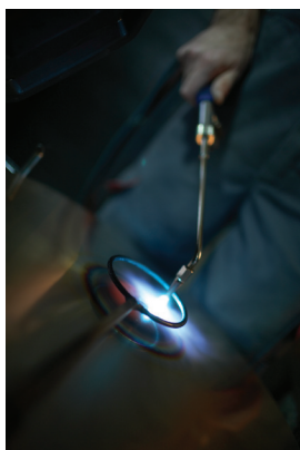
chauffage du centre
