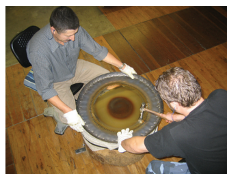
accordage circulaire au marteau
