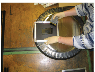
impression à partir d'un cadre en soie
