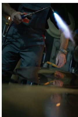
perçement du trou de la cloche par pression
