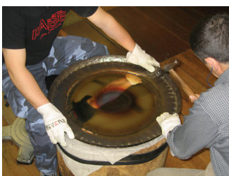
accordage circulaire au marteau
